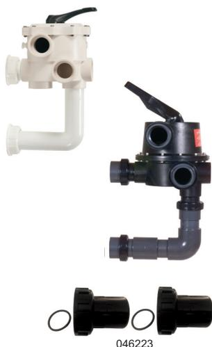
464629 **6-Wege-Ventil Astral 2" I.G.** mit Verrohrungselementen zum Filter. Lose im Karton verpackt. **Rohrabstand 230 mm** (für Art. 441615)
