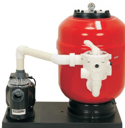
15851 **EUROPA-Kompaktfilter D 450 mm Farbe rot mit 6-Wege-Ventil verrohrt und Filterpumpe SENA D 1, 0,52 KW, Wechselstrom 230 V (steckerfertig), montiert auf Bodenplatte (ohne Filtermaterial) Abmessungen: L x B x H; 82 x 69 x 89 cm**
