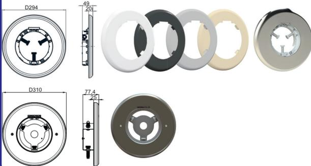
**b. Blende zur Installation in einer Mauerdurchführung**
