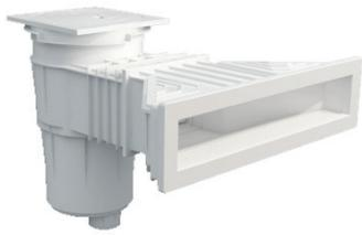
456176 **Oberflächenabsauger SLIM 500 KS, Farbe weiß mit Saugplatte u. Blende** für Beton-Folienbecken. Material ABS, mit Deckel und Überlauf D 40, 17,5 Liter, Anschluss: 1 1/2" I.G. zum Filter, 2" I.G. vom Ablauf
