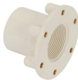
449757 **Mauerdurchführung in KS, kurze Ausführung** mit Sacklöcher für Flanschmontage, Länge 61 mm, Beckenseite 1 1/2" I.G. Anschlussseite: Klebemuffe DA 50
